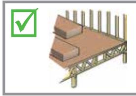
**Sí** distribuye cargas sobre el mayor número de trusses que sea posible. Posicione perpendicular a los trusses los montones de materiales llanos con la dimensión más larga como se indica el dibujo.
