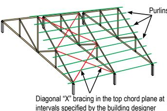
**ADVERTENCIA!** Descuidar el arriostre/restricción permanente es una causa principal de problemas de rendimiento del truss en campo y se sabe que puede provocar el derrumamiento del sistema del techo o piso.
